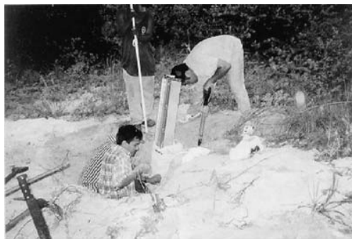
Figura 5. Extracción del monolito en un Arenosol.
