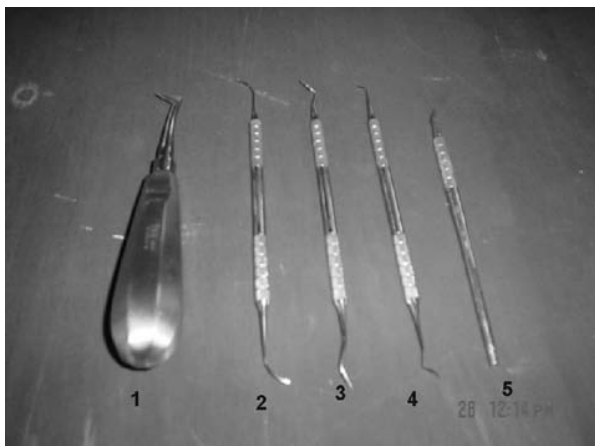
Figura 8. Instrumental de dentista para el tallado de los monolitos. 1) elevador molar No. 1; 2 a 5) ganchos profilácticos.
