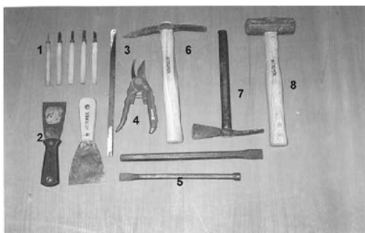
Figura 4. Herramientas utilizadas en la extracción de monolitos: 1) gurbias, 2) espátulas, 3) segueta, 4) tijera jardinera, 5) cinceles, 6 y 7) picoletas, 8) mazo.
