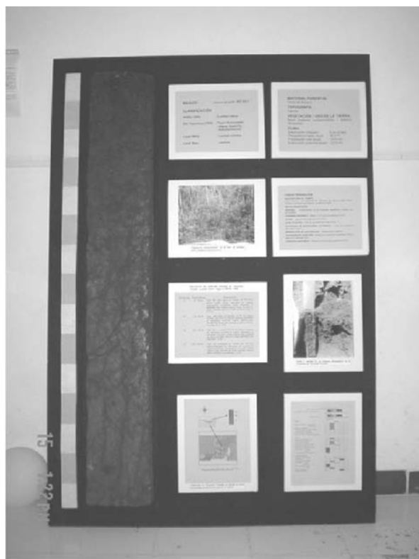
Figura 10. Monolito montado con: un mapa, fotografías de paisaje y perfil, diagrama de evaluación de tierras y su clasificación.
