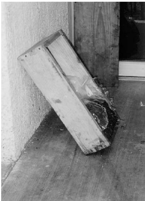
Figura 6. Monolito en etapa de secado, nótase la inclinación de la caja.
